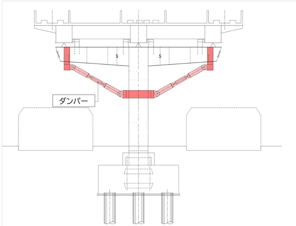
図 1 : ダンパー設置イメージ
