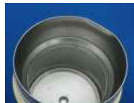
検体 C 容器変形状況
