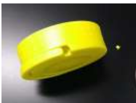
検体 B 蓋部破損状況
